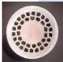
In Francia L'impianto sorgerà a Cadarache. Sotto la bobina di Asg che sarà presentata il 19 maggio e sopra un filo super- conduttivo in diboruro di magnesio
