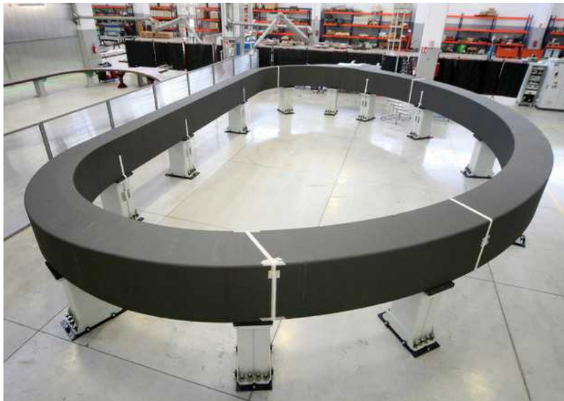
Il magnete superconduttore fabbricato in Italia e destinato al reattore sperimentale Iter © ANSA
