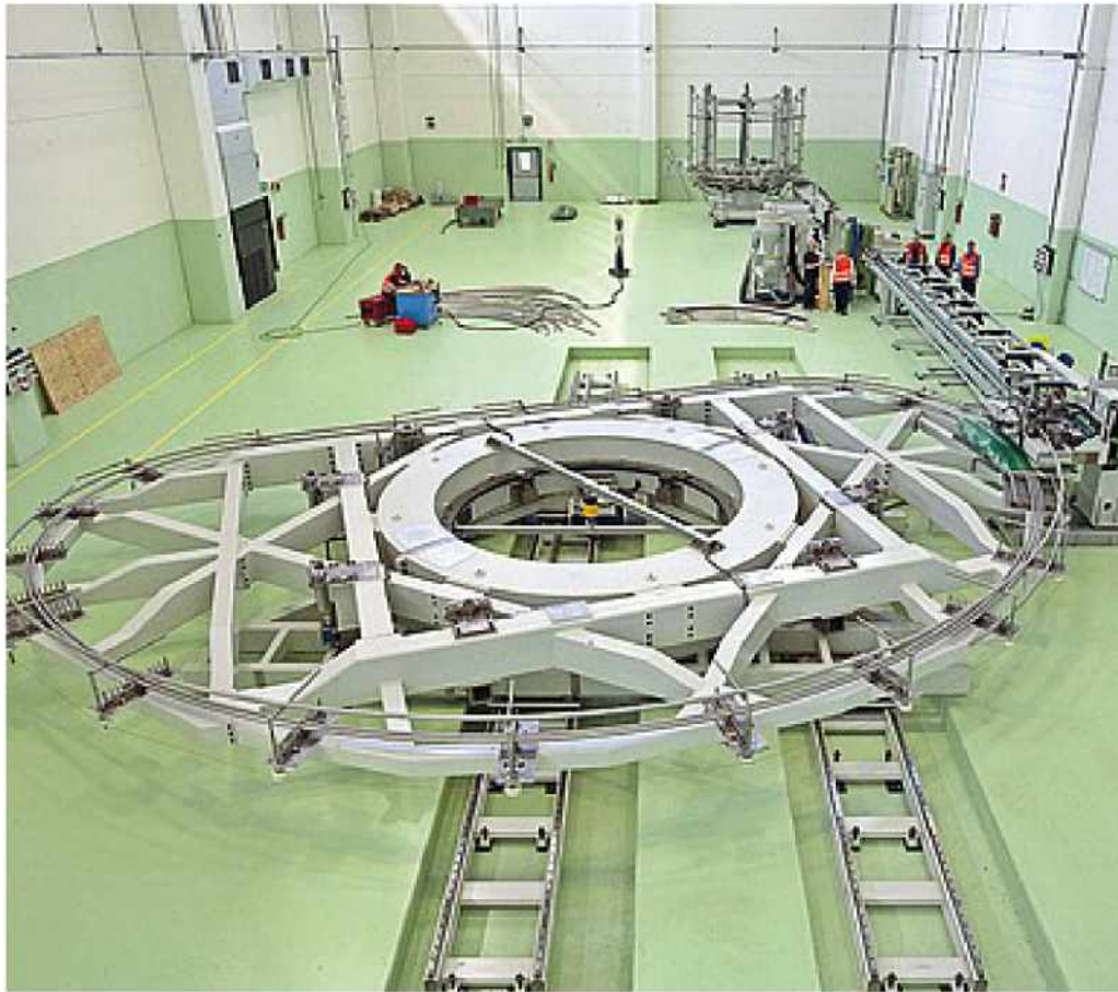
L'impianto La bobina Iter in lavorazione nello stabilimento Asg dei fratelli Davide e Mattia Malacalza
